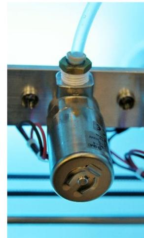
*Bild 15: Bereits eingebautes Magnetventil*
