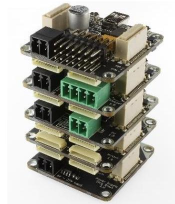
Bild 10: Stack aus 4 Bricks und der Stromversorgung
