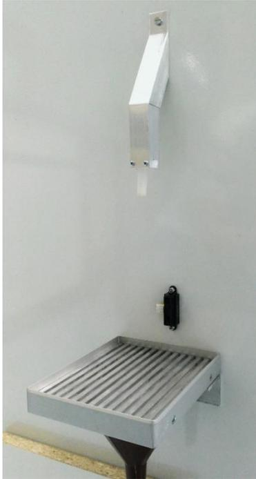
Bild 39: Der Ausschank inklusive dem Bechererkennungssensor
