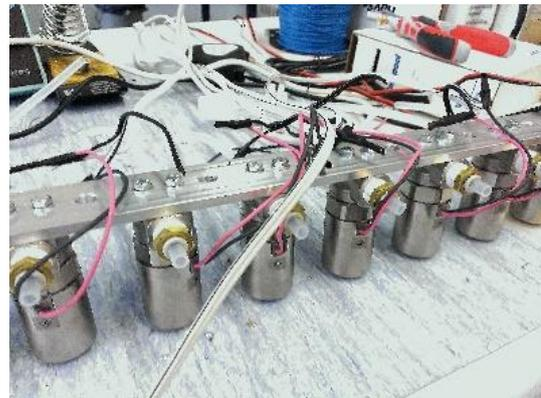
Bild 46: Löten der Ventilverkabelung
