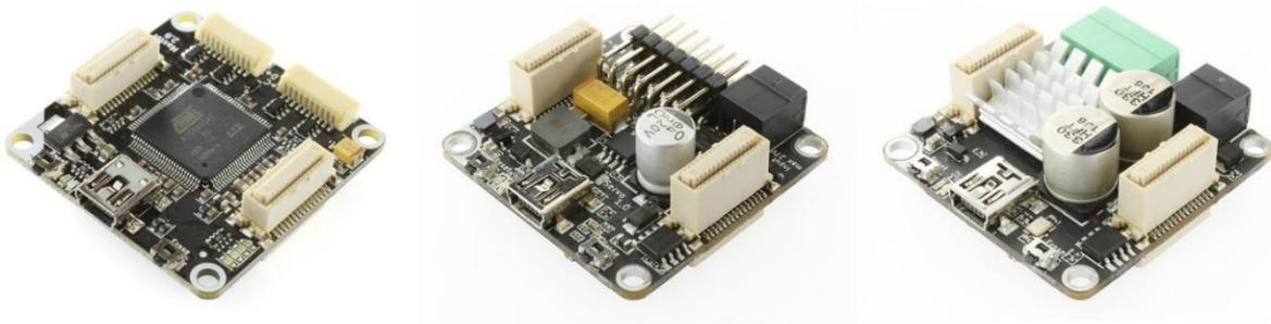
Bild 11: Master-Brick, Servo-Brick und Stepper-Brick
